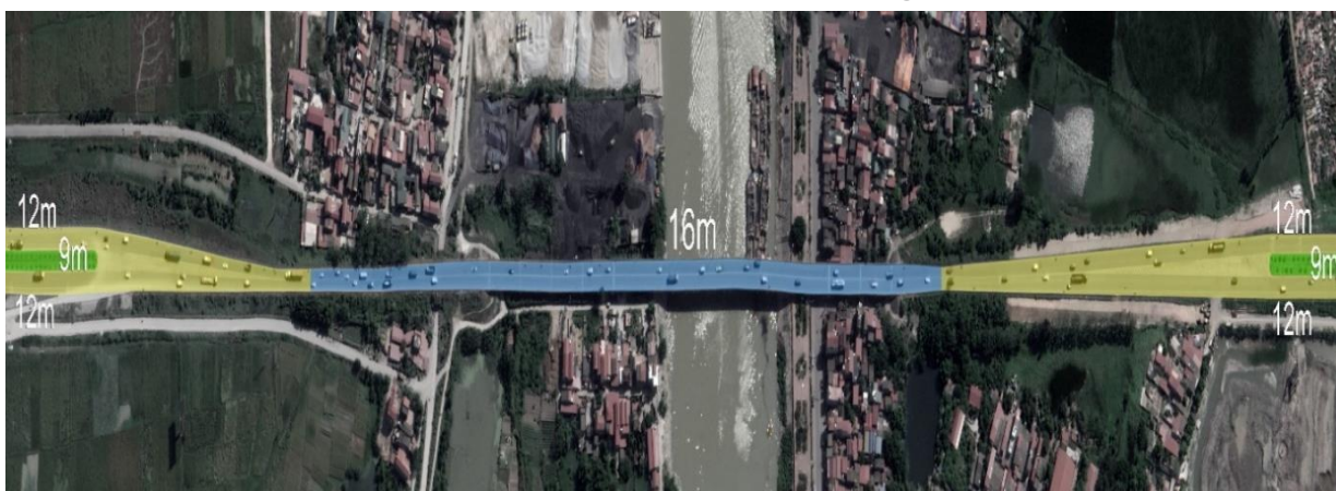
Cầu Như Nguyệt bị thu hẹp so với đường đầu cầu
